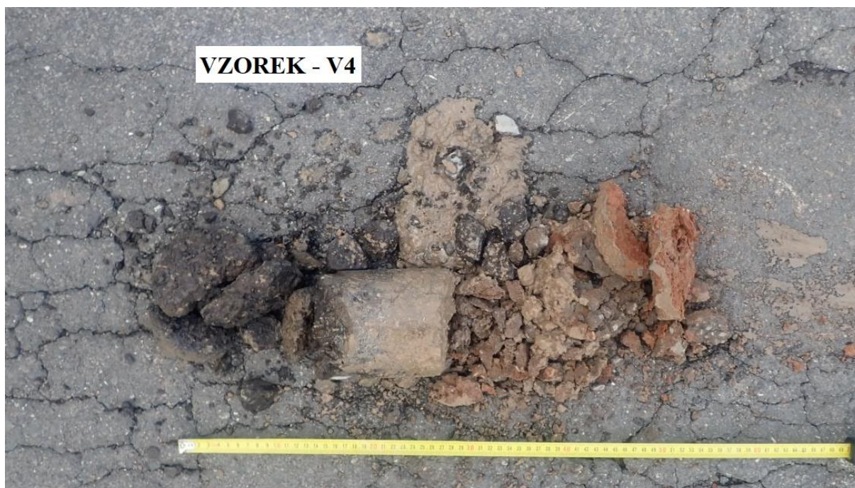
Obr. 7 - Jádro vývrtu Vzorek – V4 (in situ).
