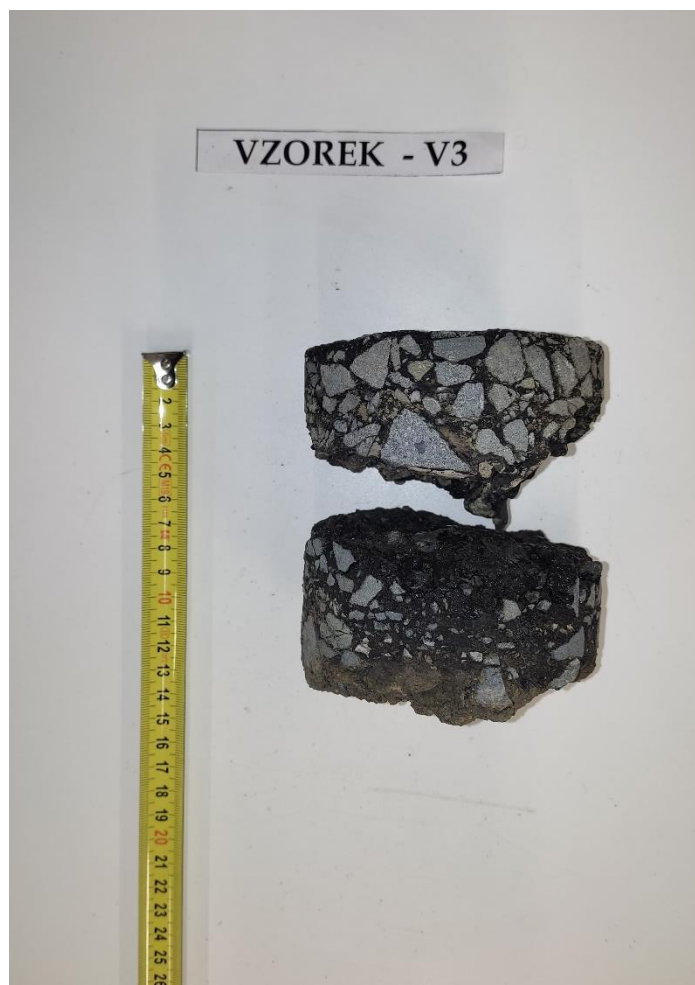
Obr. 6 - Jádru vývrtu Vzorek – V3 (laboratoř).
