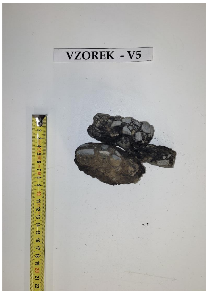
Obr. 10 - Jádro vývrtu Vzorek – V5 (laboratoř).
