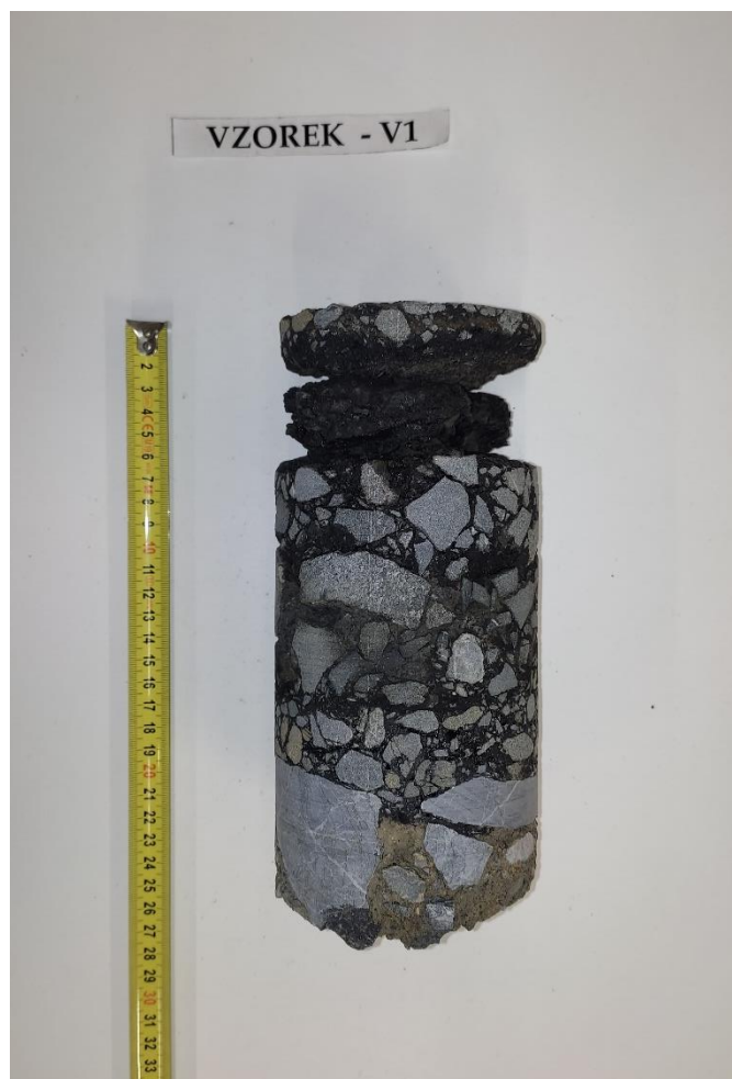
Obr. 2 - Jádru vývrtu Vzorek – V1 (laboratoř).
