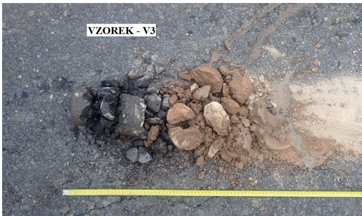
Obr. 5 - Jádro vývrtu Vzorek – V3 (in situ).
