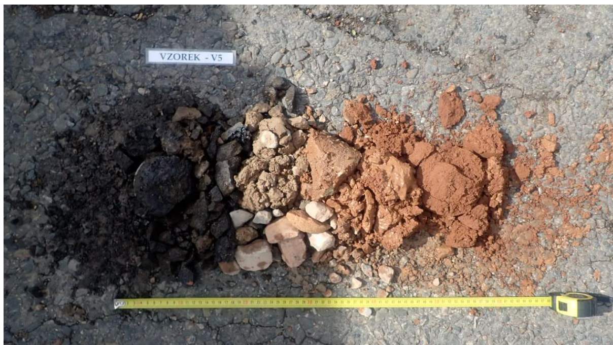
Obr. 9 - Jádro vývrtu Vzorek – V5 (in situ).
