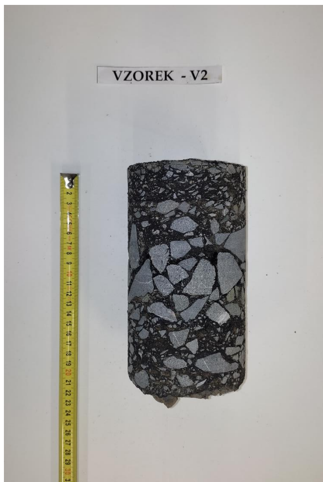
Obr. 4 - Jádru vývrtu Vzorek – V2 (laboratoř).
