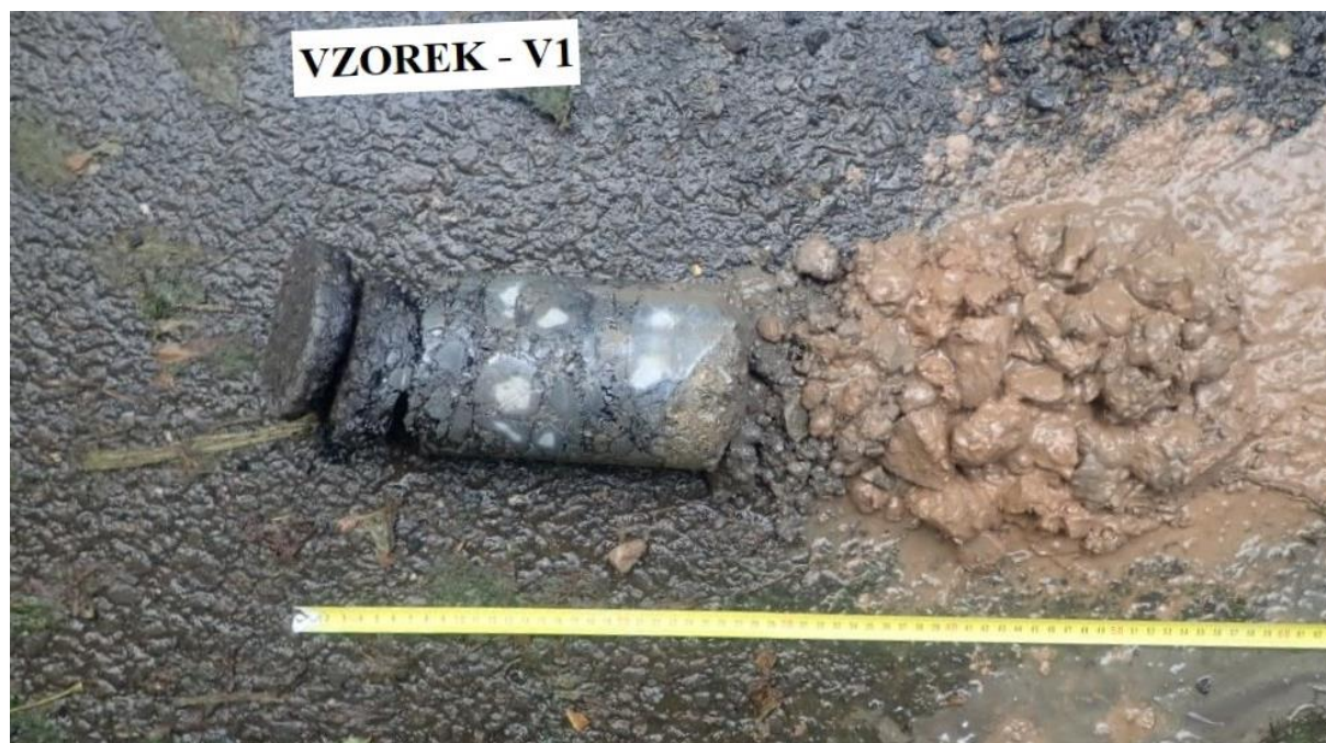
Obr. 1 - Jádro výtvetu Vzorek – V1 (in situ).
